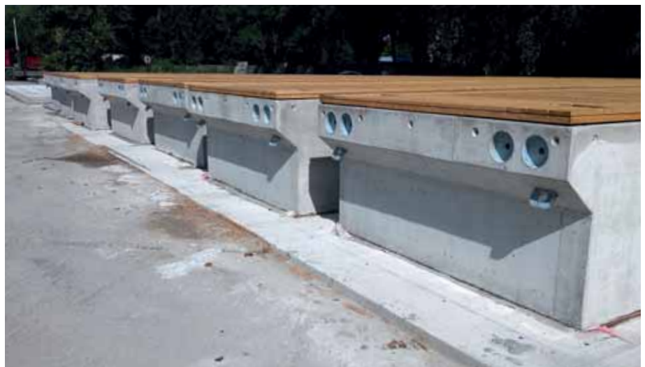
Jednotlivé moduly mariny připravené na transport
