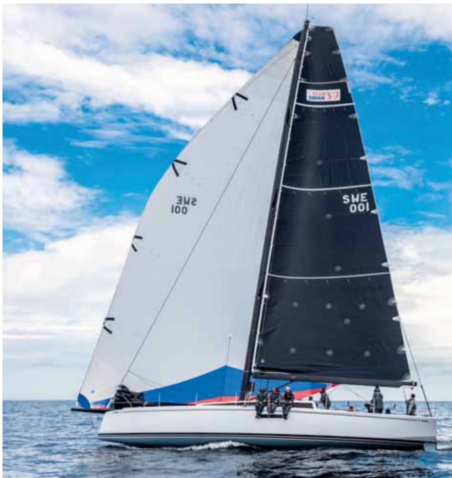
Hlavní plachta má rovný horní konec a plný tvar, což umožnil pohyblivý zadní stěh.
