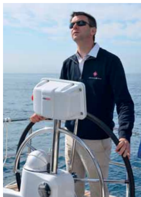
Pokud je nutné provést obrat proti větru, režim autotack jej spolehlivě zajistí a kormidelníkovi stačí jen otáčet kormidlem.
