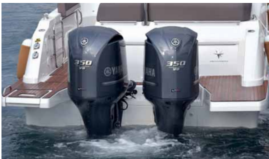
Testovaná loď byla vybavena dvěma motory Yamaha V8 o výkonu 350 HP a chytrým systémem řízení pro snazší manévry pomocí joysticku.
