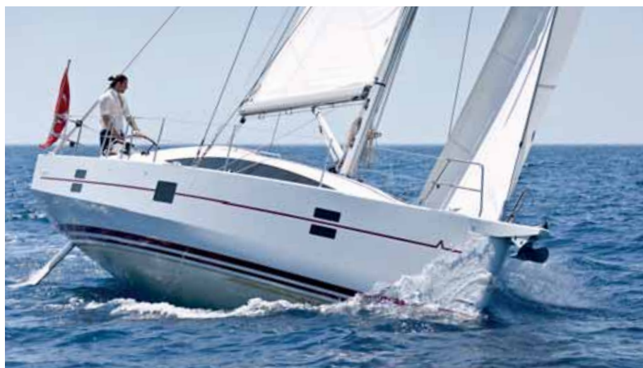
Celospírová hlavní plachta s dvěma refy a kosátkou zaujímá celkovou plochu 100 m 2 .
