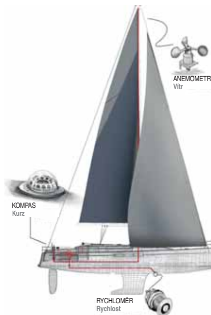
Systém AST potřebuje data o rychlosti, směru a rychlosti větru a o kurzu loď.
