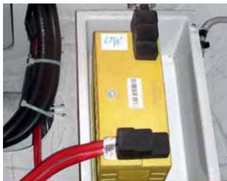
Lithiová baterie 60 Ah pro pohon thrusteru poskytuje větší výkon a trvanlivost než původní 120 Ah akumulátor.
