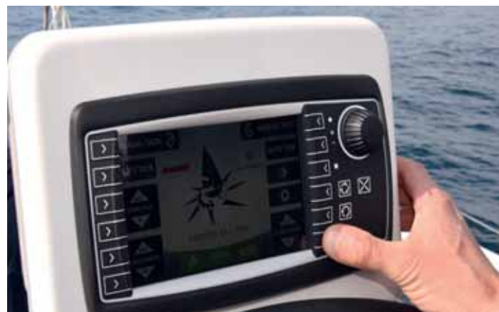
Nedílnou součástí systému AST je v kokpitu umístěný displej, z něhož se ovládají všechny funkce.
