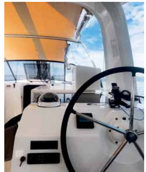
U kormidla chybí mapový plotr. Je nahrazen tabletem s mapami Navionics, který se upevní do připraveného držáku.
