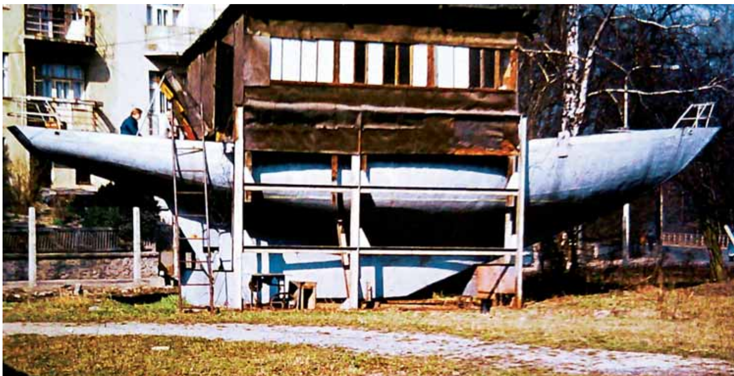
Trup ocelového keče MARTIN byl do Brna přivezen v kleci z úhelníků, do níž byl kvůli přepravě vevařen. Dřevěnou boudu nad otevřeným středolodím postavili Jarda Dřevo a Rudolf Roháček, který na lodi pracoval jako placený zaměstnanec a přiděloval práci brigádníkům.
