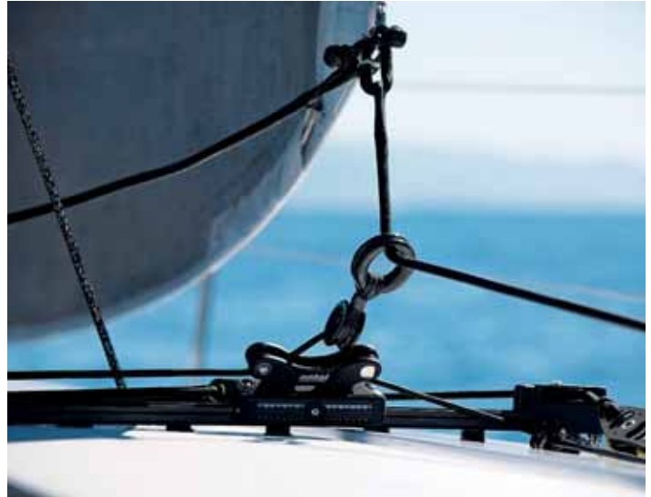
Pokud majitel preferuje jednoduché ovládání, bude volit samopřehazovací kosatku na rolfoku.
