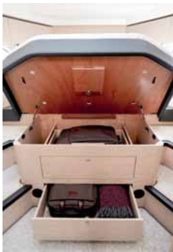
Pod vyklápěcím lůžkem je velký prostor, třeba na uložení zavazadel, který je přístupný i předními dvířky.
