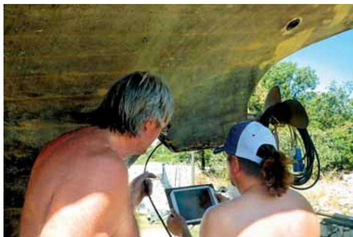
Kontrola stavu kokerovy trubice pomocí eudoskopu.
