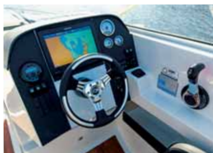
Kormidelní konzole vévodí černá přístrojová deska s displejem navigačního počítače uprostřed a trojicí motorových přístrojů vpravo nahoře.
