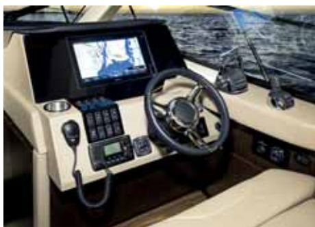
Na palubní desce upoutá velký displej Garmin, na němž se zobrazují kromě údajů z mapové GPS a radaru i všechny informace o motorech.
