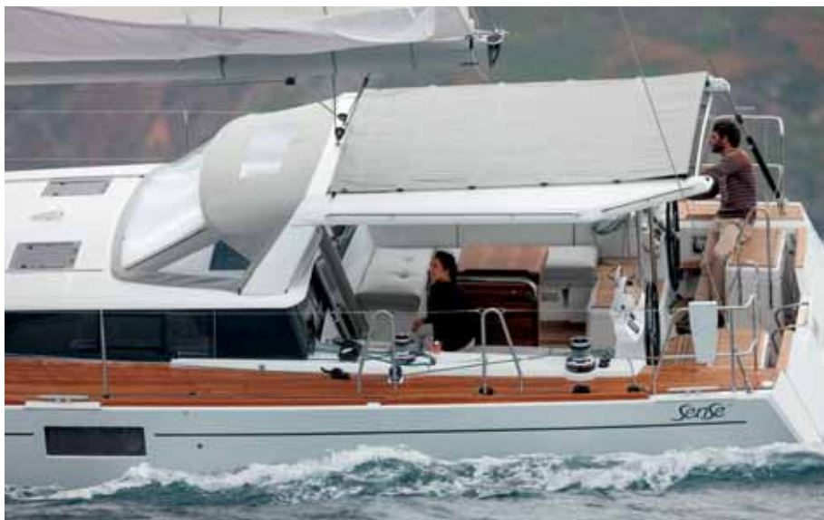
Kokpit chrání hard top s látkovou střechou, kterou lze sbalit, vyrobenou ze speciálního materiálu.
