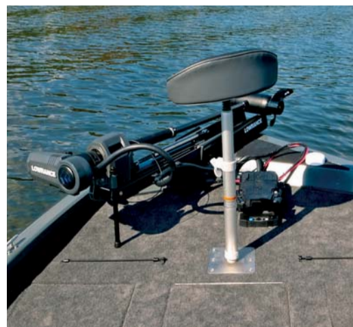
Elektromotor s nožním a dálkovým ovládáním a polosedáčku na přídi ocení především rybáři.
