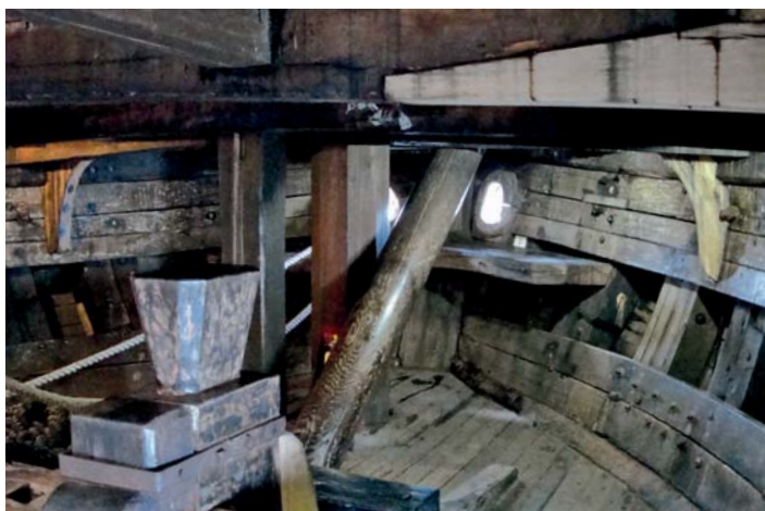
Pohled do přední nástavby ukazuje uložení čelenu, vodorovný kotevní vrátek a mohutné pachole, na něž se vázalo kotevní lano.
