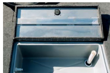
Vzadu je vestavěná schránka na živou návnadu s cirkulací vody.
