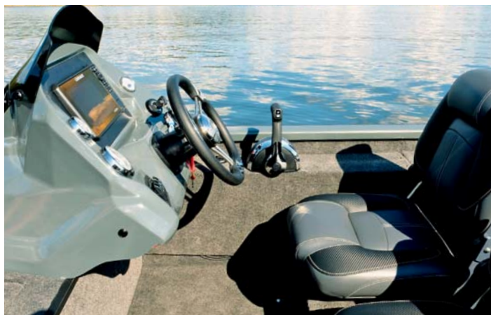
Pracoviště kapitána je chráněno nízkou konzolí řízení, na kterou se vejde echolot HDS 9 s mnoha dalšími funkcemi.
