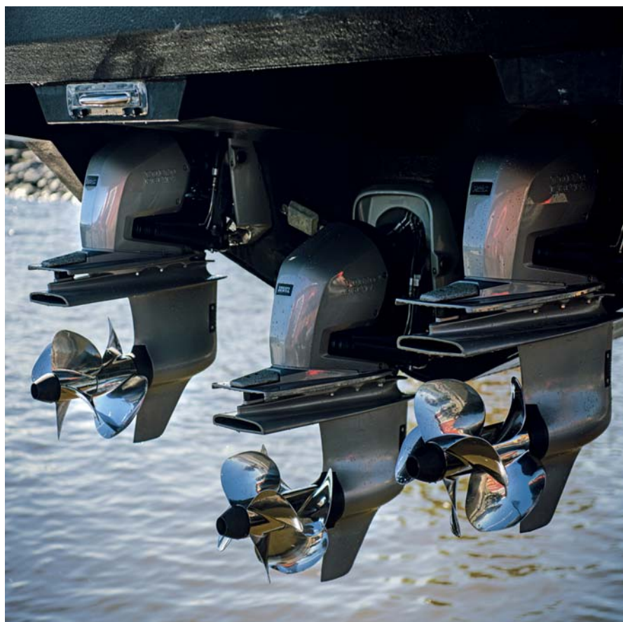
Trojmontáž umožňuje instalaci na větší lodě do 60 stop délky.
