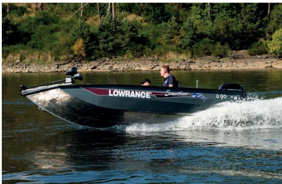
Za stabilitu může ploché dno a šířka lodi.
