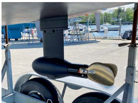
Zabudovaný elektromotor se sklopnou vrtulí
