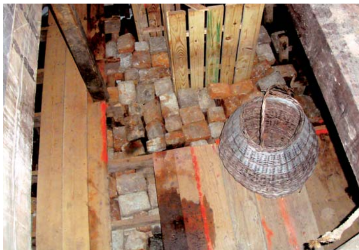
Kromě elektrického osvětlení kvůli bezpečnosti návštěvníků je ústupkem proti originálu i balast tvořený litinovými kostkami. Původní MAYFLOWER měla jako zátěž kamení.
