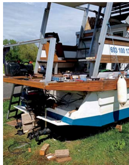
Týden před spuštěním lodě na vodu ještě probíhaly dokončovací práce. Je zde dobře vidět kombinace dvou elektromotorů a jednoho spalovacího motoru.
