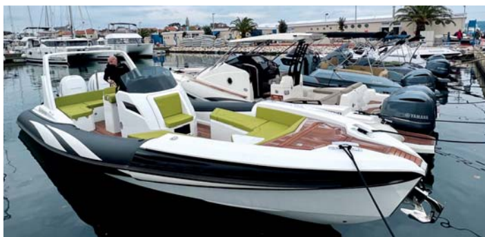
Tady zašli designéři hodně daleko a nafukovací válce jsou jen pro stabilitu v zadní části trupu.
