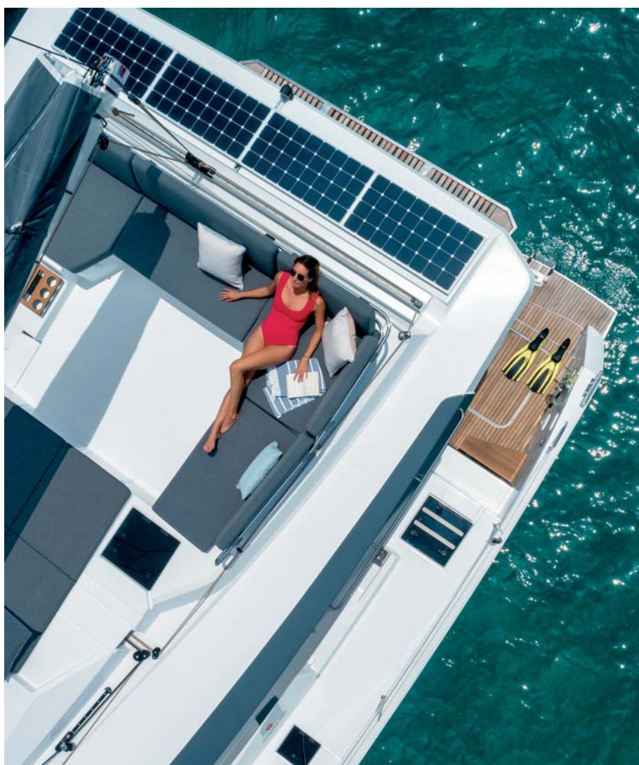
Úplný konec střešky nástavby lze využít pro instalaci solárních panelů.
