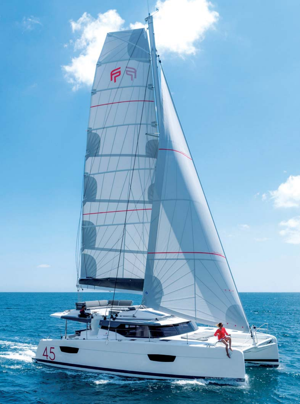
Hlavní plachta má velmi širokou hlavovou část, což dává tušit velmi dobré výkony na plachty.
